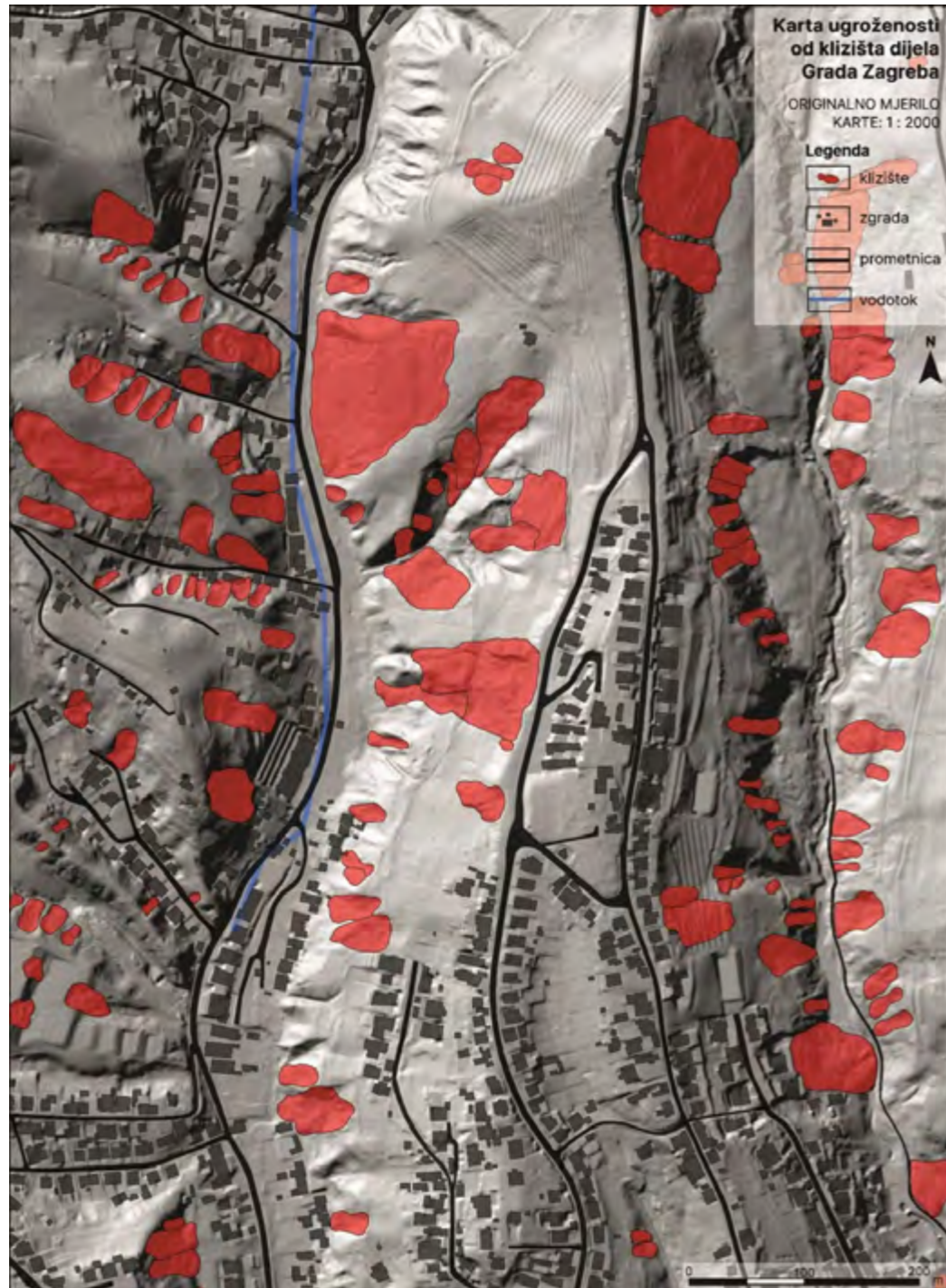
Slika 6.5 Isječak iz Karte inventara klizišta dijela Grada Zagreba mjerila 1:2.000 s prikazom elemenata pod rizikom (zgrade, prometnice, vodotok).
